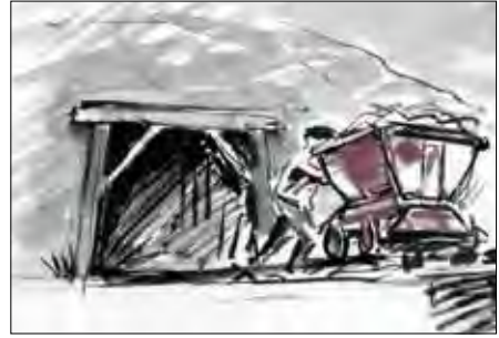
Beim Untertagebau mussten Stollen, die mit Fichtenspösten abgestützt waren, in den Hang gegraben werden
